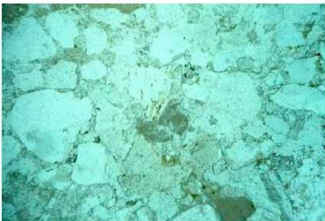
Foto č.5 Hrubozrnný kremenno - vápenatý pieskovec – vzorka č.3 – južný vstupný portál východná stojka. Ostrohranné úlomky zŕn sú stmelené obal'ujúcim tmelom. V tejto vzorky sú úlomky skôr ostrohranné, brekciovité. Obyčajné svetlo, zväčšenie 20x.
