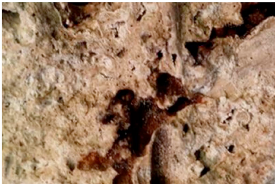
Foto č.10 Penovec – vzorka č.6 – Stavebný a výplňový materiál, exteriér. Ide o pórovitú vápenatú horninu, vznikajúcu aj dnes z prameňov bohatých na uhličitán vápenatý. Obyčajné svetlo, zväčšenie 10 x.
