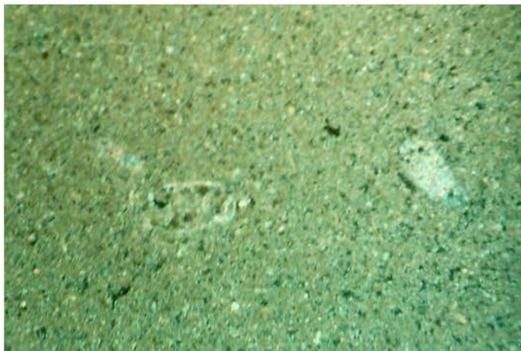
Foto č.10 Sivočierny gutensteinský vápenec -- vzorka č.5 – Epitafná doska, interiér. Ide o jemnozrnnú čiernu horninu. Táto hlbokomorská sedimentárna hornina obsahuje aj stopy po vápenatých schránkach morských živočíchov. Svetlé časti sú kryštály kalcitu. Výbrus horniny, polarizované svetlo, zväčšenie 40 x.
