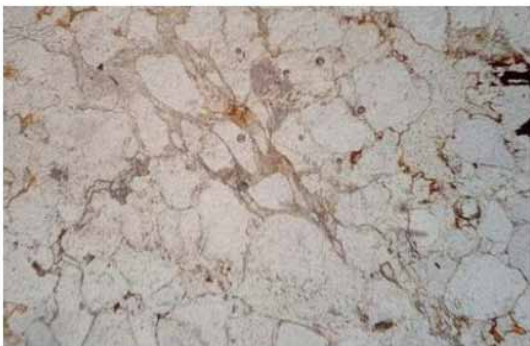
Foto č. 2 Jemnozrnný okrový pieskovec, Svätencička v pilastrí. Mikroskopický záber zobrazuje priehľadné zrná kremeňa a živcov stmelené kryštálmi kalcitu s obsahom oxidov železa. Tmel je sieť čiar na okraji zrn. Obyčajné svetlo, zväčšenie 30 x.
