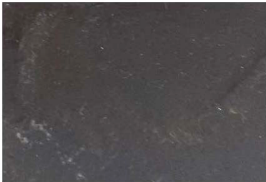
Foto č.9 Sivočierny gutensteinský vápenec -- vzorka č.5 – Epitafná doska, interiér. Ide o jemnozrnnú čiernu horninu. Kalové jemné vápenaté súčasti, spolu s ílom a bitúmenmi tvoria čiernu farbu horniny. Obyčajné svetlo, zväčšenie 10x.
