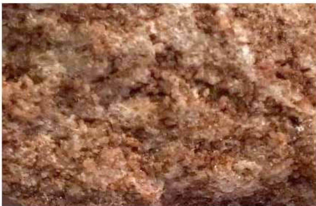
Foto č. 1 Jemnozrnný okrový pieskovec, Svätencička v pilastrí. Makroskopický záber zobrazuje rovnomerne veľké zrná kremeňa stmelené kryštálmi kalcitu s obsahom oxidov železa. Obyčajné svetlo, zväčšenie 10 x.
