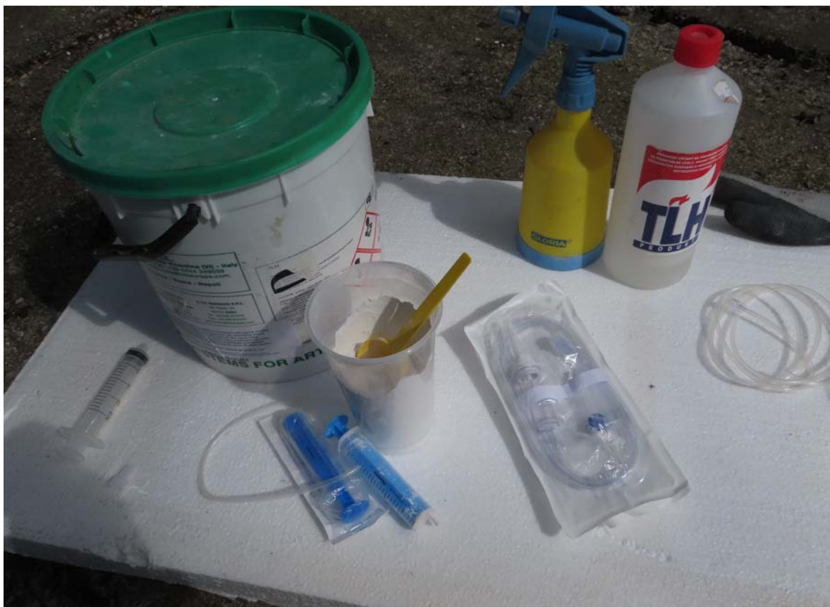
Príprava injektážnej malty PLM-AL
